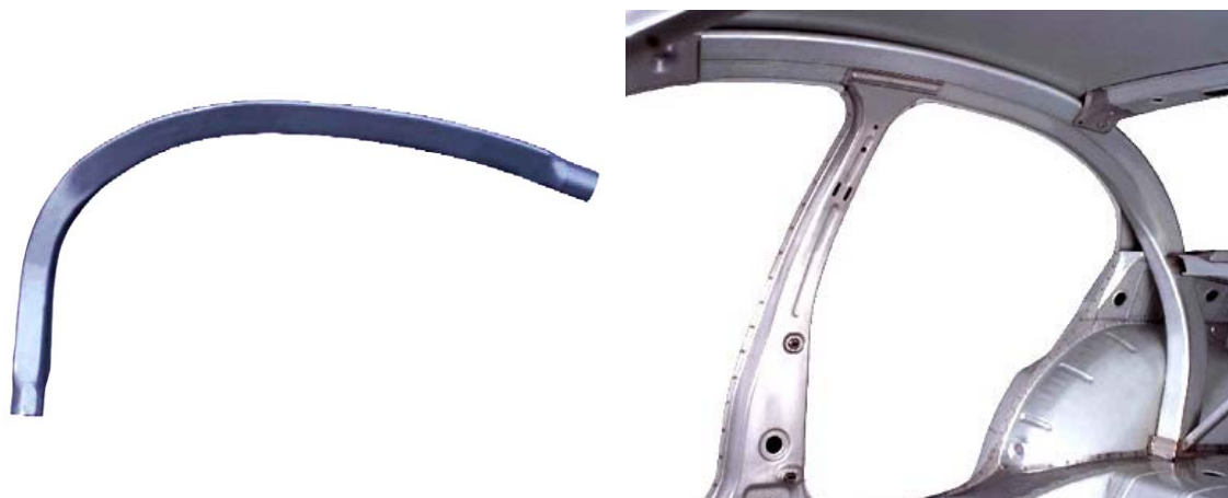
Fig. 3.1.5 - Elemento longitudinale idroformato della scocca ULSAB (fonte: [3.8])
