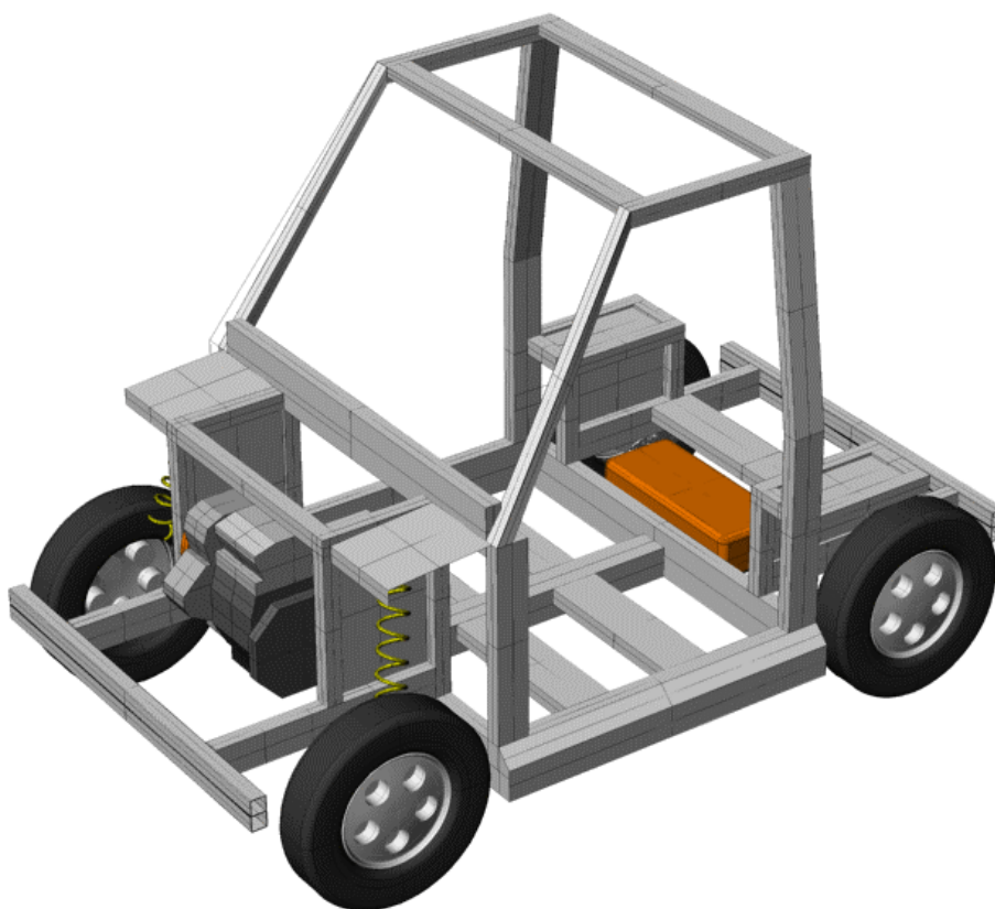
Fig. 5.5.1 - Struttura ottimizzata con principale disposizione degli organi meccanici
